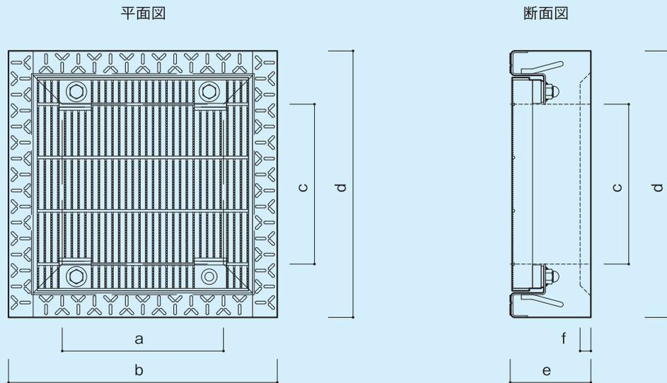
※高耐食性の溶融亜鉛-アルミニウム-マグネシウム合金めっき鋼板です。
